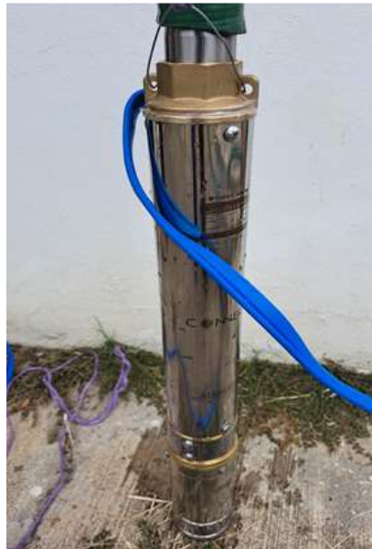
Figura 3. Bomba de 300 watts utilizada para el funcionamiento del sistema de riego.
