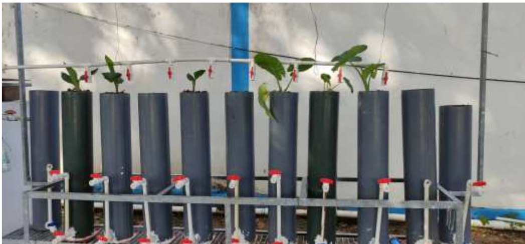
Figura 1. Sistema humedal artificial prototipo montado inicial.
