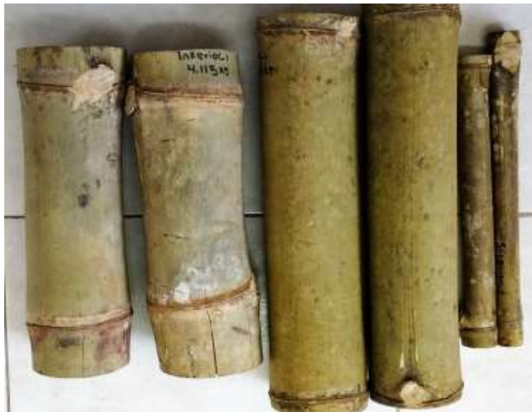
Figura 1. Muestras de secado obtenidas de la parte basal, media y superior de los culmos de Guadua aculeata .
