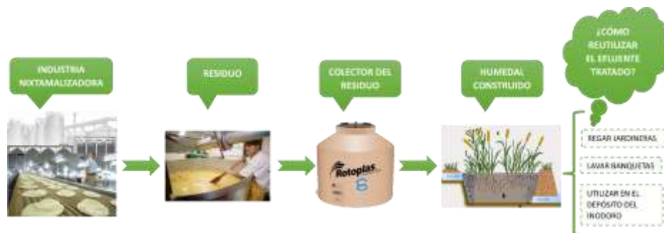
Figura 3. Sistema Bioingenieril de humedales construidos para el tratamiento del nejayote.
