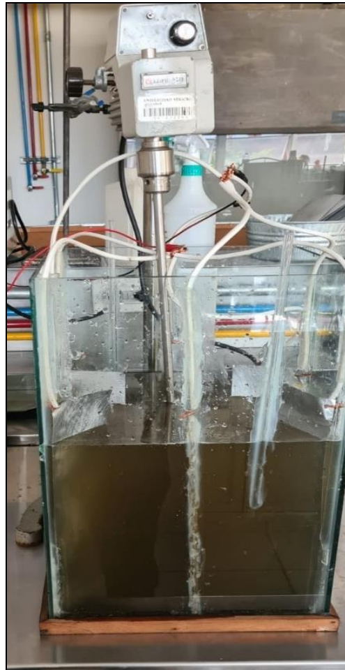
Figura 1. Reactor por lotes en operación.
