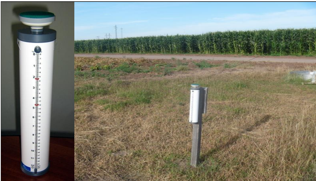
Figura 1. Atmómetro instalado en la zona de estudio.
