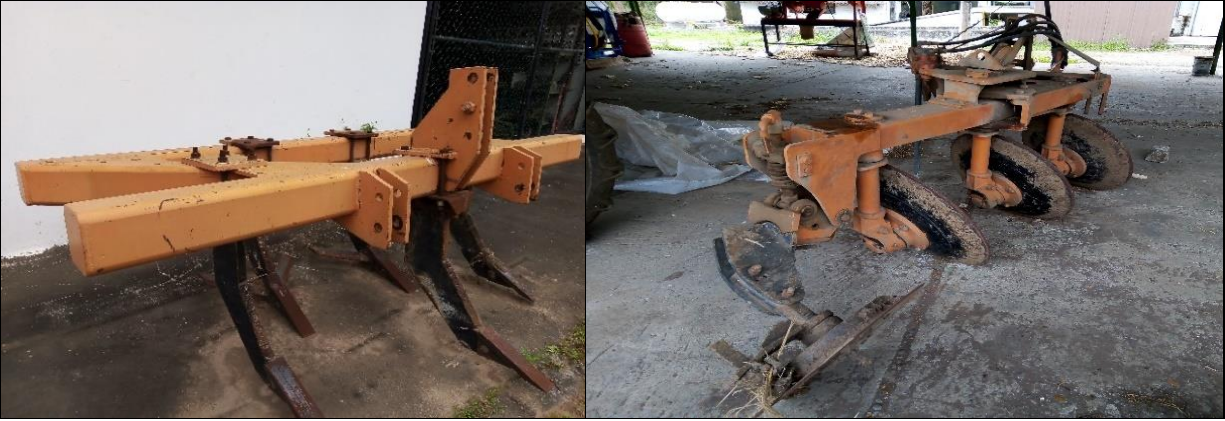
Figura 2 y 3. Arado de cinceles (a) Vs. Arado de discos (b).
