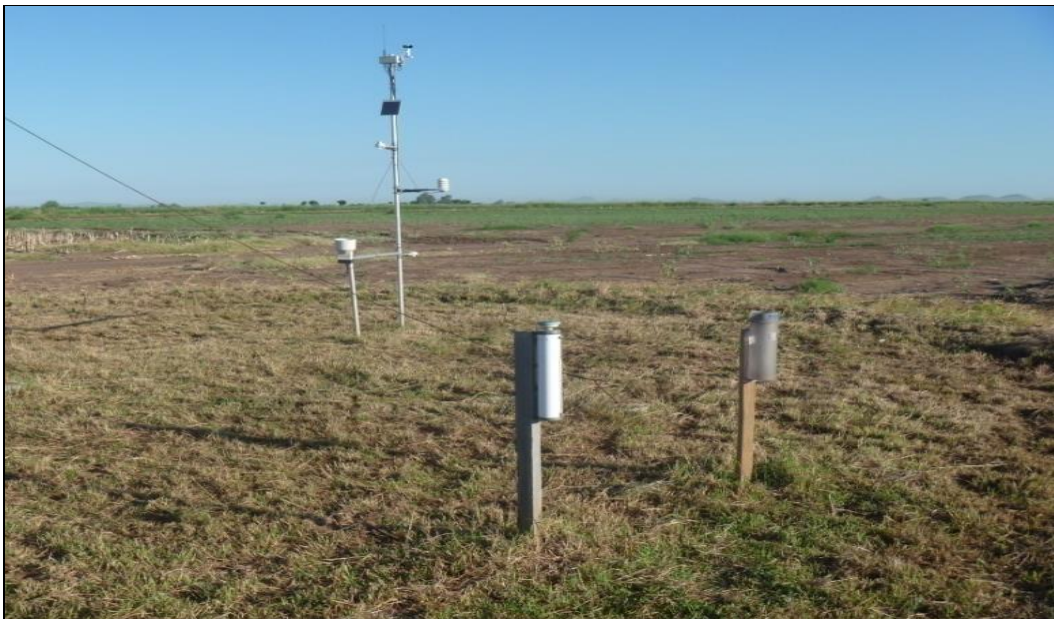
Figura 2. Atmómetro instalado junto a una estación meteorológica automática.
