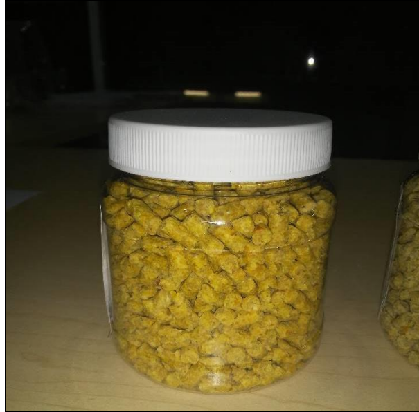
Figura 2. Muestra de pellet tomada del enfriador; humedad 11.50, IDP 88.90, rendimiento 22.40 t/h.
