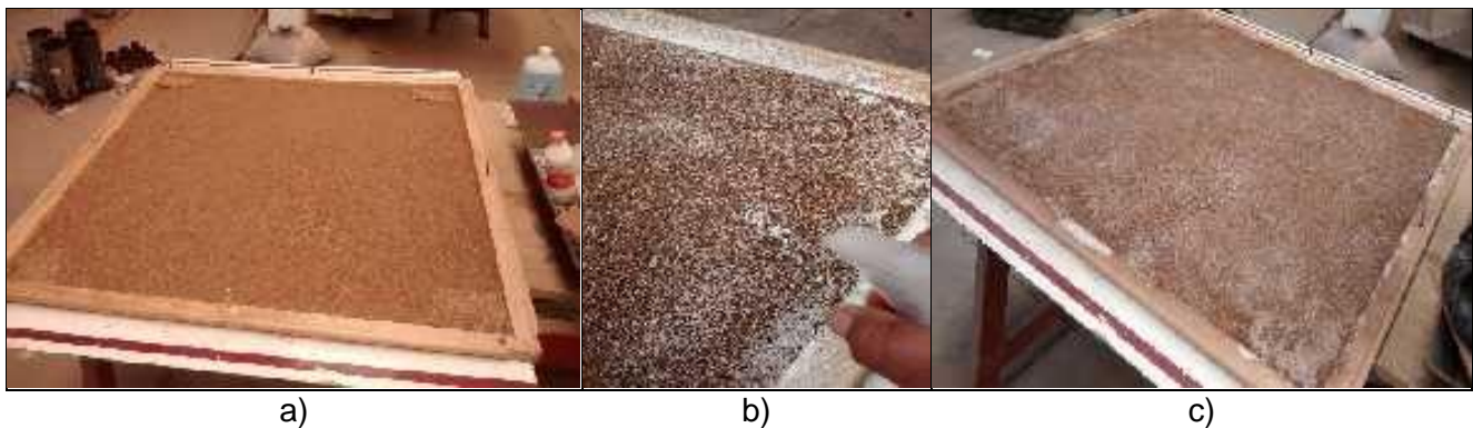
Figura 5. Fabricación del panel biocompuesto por capas y atomización.
