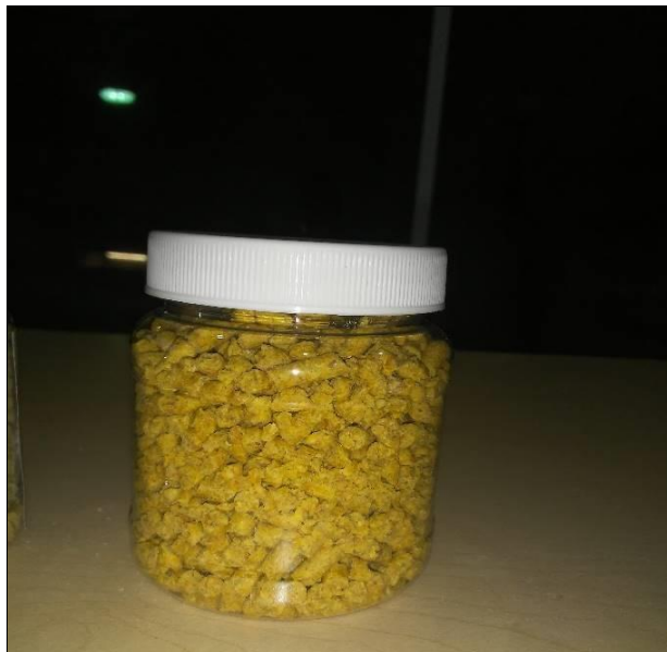
Figura 1. Muestra de pellet tomada del enfriador; humedad 10.83, IDP 77.04, rendimiento 20.00 t/h.
