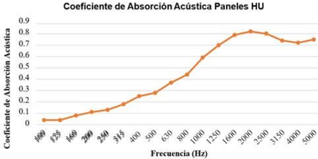
Figura 6. Medición del coeficiente de absorción acústica por tercios de octava de los paneles bajo la norma ASTM C 423, en la condición de Cámara Reverberante.
