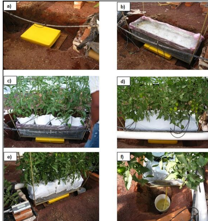
Figura 1. Procedimiento para la instalación de un lisímetro de pesada para medir la transpiración en cultivos en sistemas intensivos.
