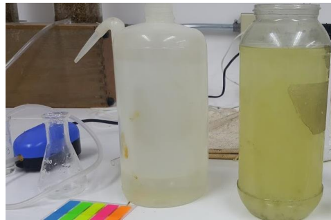
Figura 1. Bomba de inyección de aire y muestra de agua residual.
