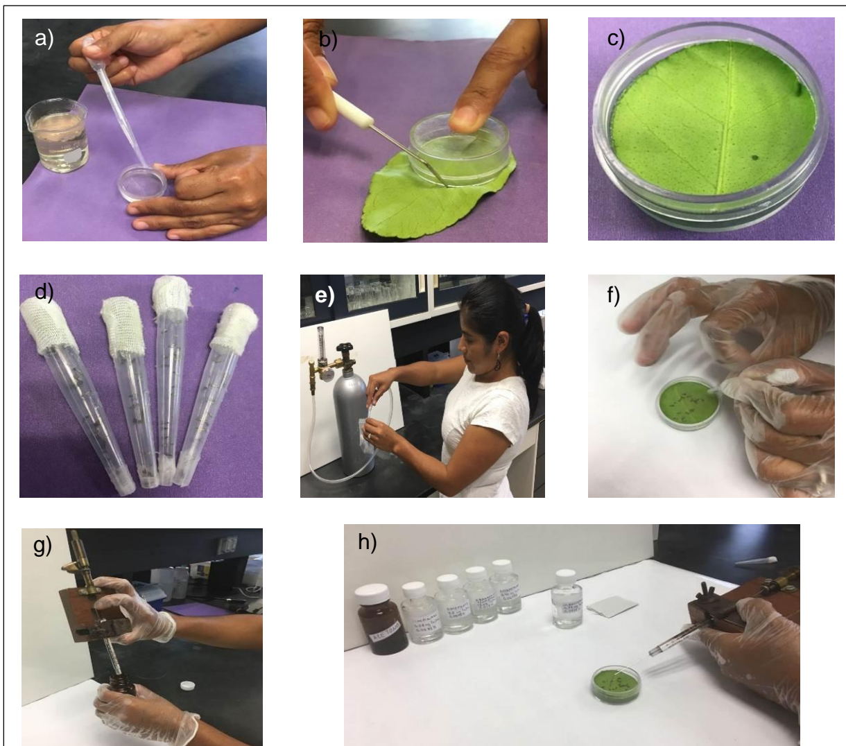
Figura 1. Proceso de aplicación de insecticidas. a) Vaciado de agar-agar en caja Petri; b) corte de disco de hoja cítrica; c) disco de hoja en base agar-agar; d) adultos de D. citri en puntas colectoras, y e) insectos anestesiados con CO 2 ; f) adultos en caja Petri; g) llenado de jeringa con producto, y h) aplicación de insecticida sobre el pronoto del insecto.
