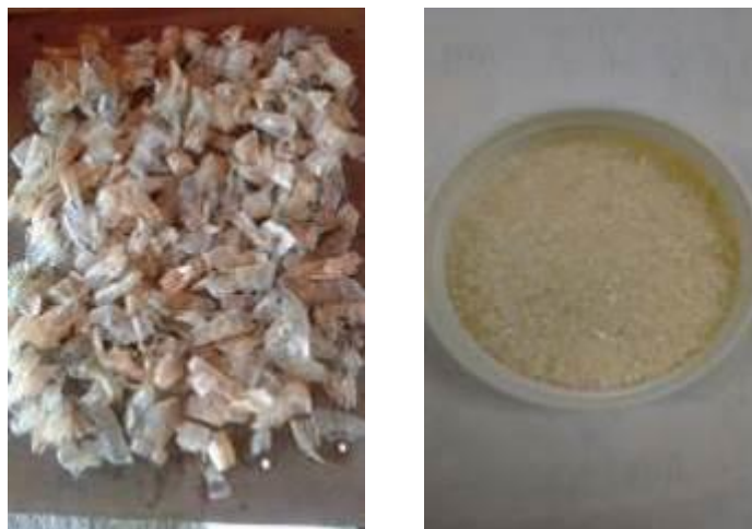
Figura 2. Muestra de exoesqueleto de camarón (izquierda) y quitosano obtenido (derecha).
