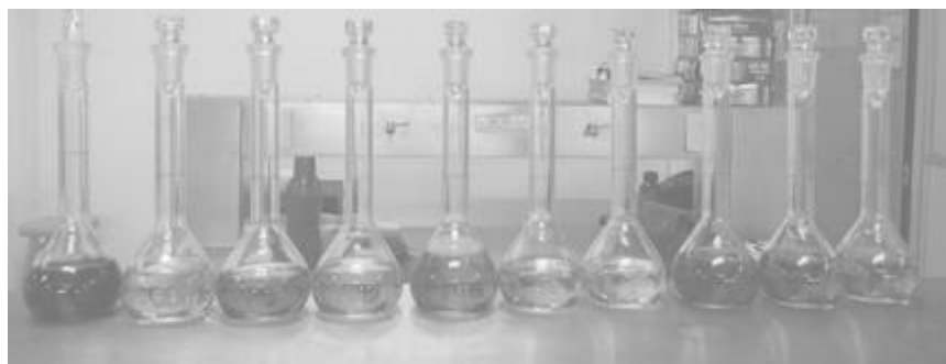
Figura 1. Matraces aforados con la solución final para el análisis por espectrofotometría de absorción atómica (EAA).
