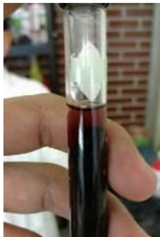
Figura 2. Extracto con solución acuosa de NaOH al 5%.
